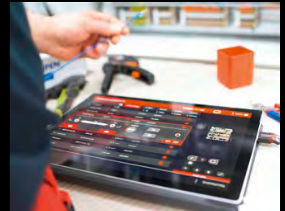
Eplan Smart Wiring: Die Software ist ein virtueller Assistent bei der manuellen Verdrahtung im Schaltschranksbau: Vom Anschlusspunkt bis zum exakten Verlegeweg stellt die Software alle notwendigen Informationen in digitaler Form bereit – bei Bedarf auch in 3D.
