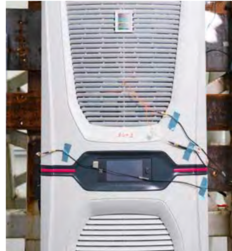
Auf „Herz und Nieren“ geprüft: Unter Laborbedingungen werden Vibrationen nachgestellt, wie sie durch einen Schiffsdieselmotor auf einem Schiff erzeugt werden, und deren Auswirkungen auf Kühlgeräte gemessen.
