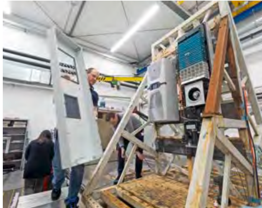
Vibrationstest: Die Geräte sind auf einer Rüttelplatte fixiert. Um Stöße aus ganz unterschiedlichen Richtungen zu simulieren, werden die Tests auf verschiedenen Achsen durchgeführt.
